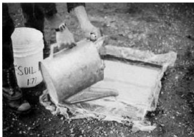
Figura 165 - 4. Vertimiento de arena dentro de la plantilla
