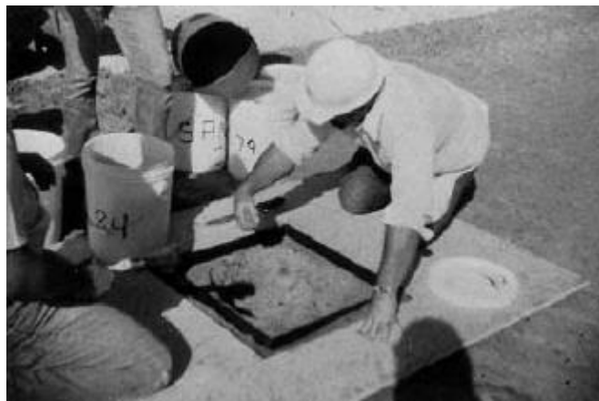
Figura 165 - 5. Excavación del pozo de ensayo
